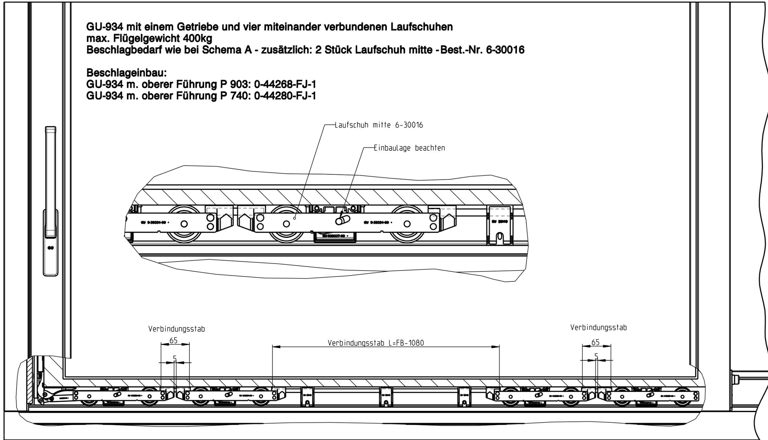
**GU-934 mit einem Getriebe und vier miteinander verbundenen Laufschuhen**
